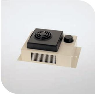
LA 09 ist ein PTC Heizlüfteraggregat zur Klimatisierung und zum Schutz vor Kondenswasser- und Frostbildung. Dieser Schnellheizeinsatz besteht aus einem Radialheizlüfter und einem PTC Heizregister in formstabilem Kunststoffgehäuse.
